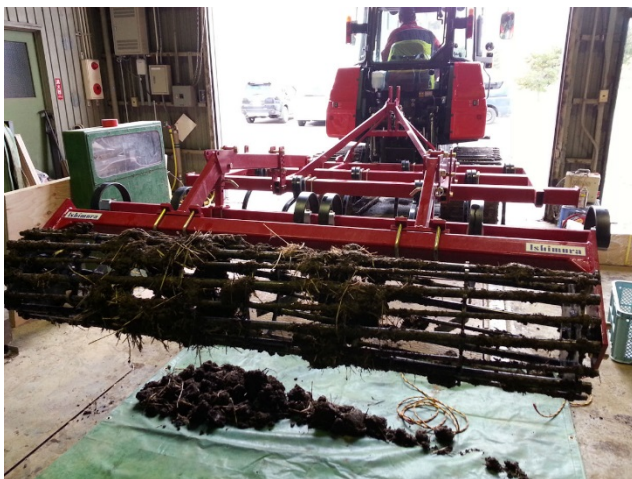
図1 畑用ローラーユニットへの土壌付着
