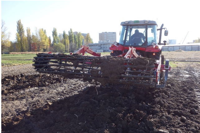
図1 畑用ローラーユニットへの土壌付着
