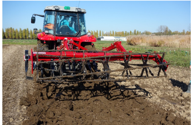
図2 湿田用ローラーユニットへの土壌付着
